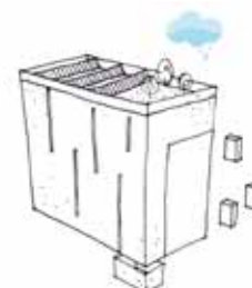
10.TRIN Ny tilbygning, ny boligform Øget boligareal Energiproduktion - solceller Ny tilbygning af vinterhaver og plantealtan Fleksible udendørsophold Lysreflektor på facaden Optimering af dagslys Glaskarnapper Regnvandsopsamling
